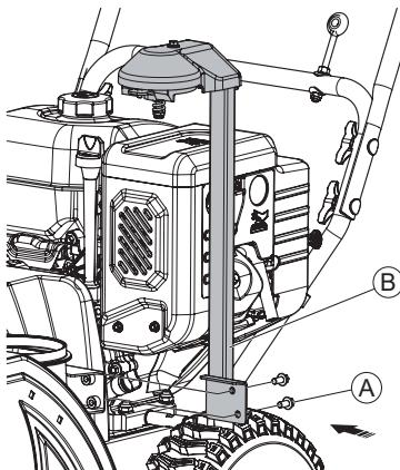
Установите поворотный механизм (B) на кронштейн снегоуборщика и закрепите при помощи болтов (A). Используйте крепёжные элементы из бокса №6: (A) болт M8x16 – 2шт
