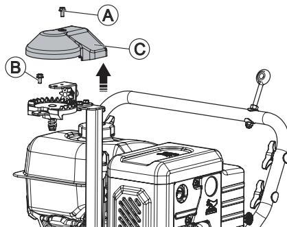
Снимите верхнюю крышку, установите и закрепите поворотный желоб используя крепеж из бокса №8: (A) болт M8x16 – 1 шт.
