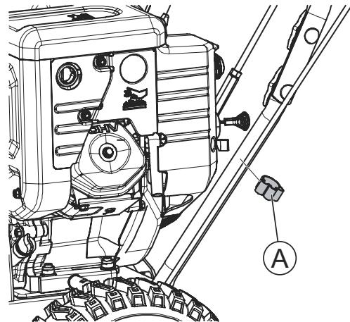
Совместите отверстия нижней и верхней рукояток, и закрепите при помощи болтов и пластиковых барашковых гаек. Используйте крепёжные элементы - бокс №3: (A) болт M8x50 – 4шт.; (B) фигурная шайба – 4 шт.; (C) барашковая гайка M8 - 3 шт. Затяните болты от руки. Закрепите трос привода шнеков.
