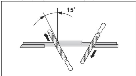
**Примечание:** Если диск сильно изношен, затачивайте кромки зубьев плоским напильником. Продолжите заточку круглым напильником.
