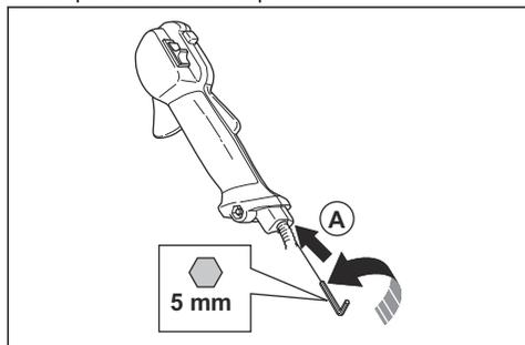
4. Если частота вращения при пусковом положении дросселя превышает 6500 об/мин, поверните регулировочный винт (A) против часовой стрелки. Когда режущее оборудование начнет вращаться, поверните регулировочный винт (A) на 1/2 оборота по часовой стрелке.
