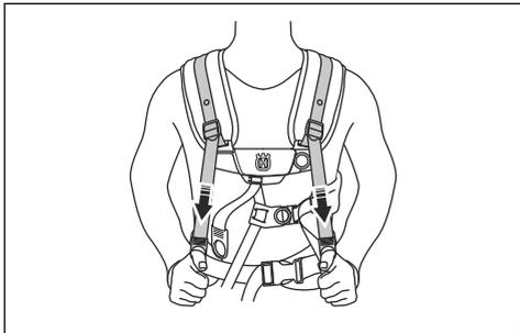
11. Отрегулируйте боковые ремни вокруг грудной клетки таким образом, чтобы нагрудная пластина располагалась по центру груди.
